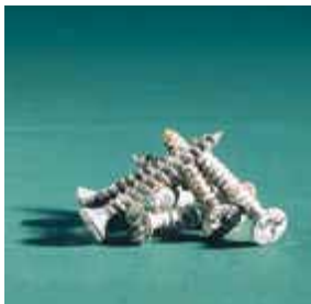
Abbildung 5.1 Zinkkorrosion (Weißrost) an galvanisch verzinkten Schrauben
